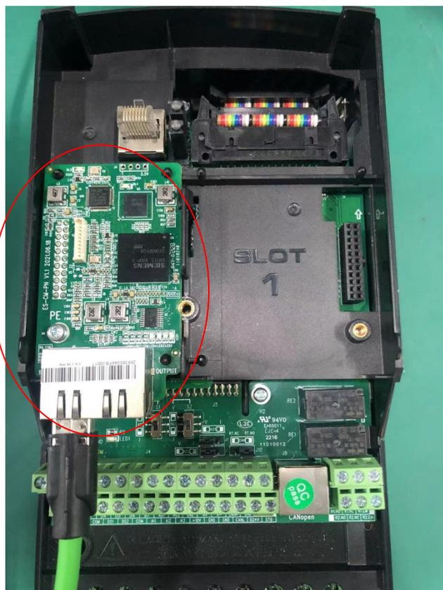
图 2-1 Profinet 卡安装方式
